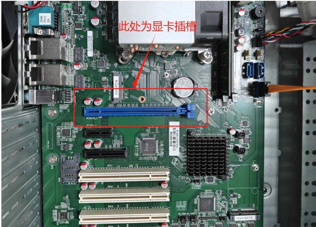
备注：显卡的金手指不能有脏污，显卡要紧靠插槽；不持外部供电的显卡。
